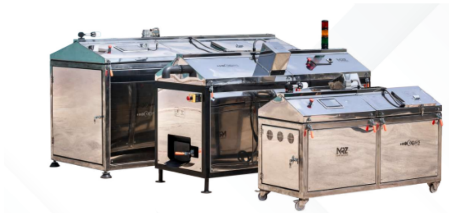
Figuur 13. Compostreactoren voor verschillende schalen (thuis, straat, afvalverzamelcentrum) [60]
